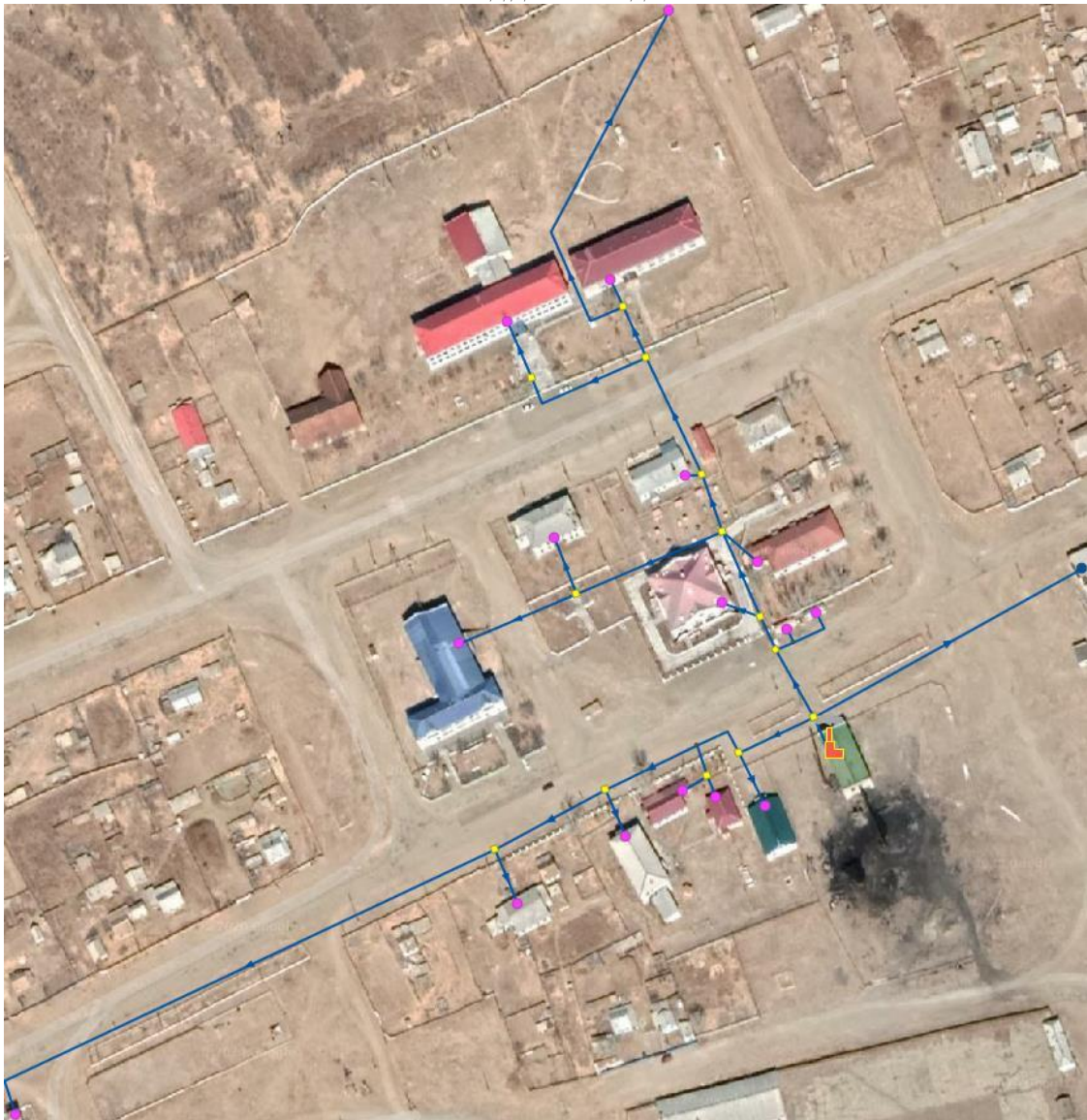
Рисунок 3.1.1. Электронная модель системы теплоснабжения сельского поселения «Гунэй» в программе ZuluThermo8.0
