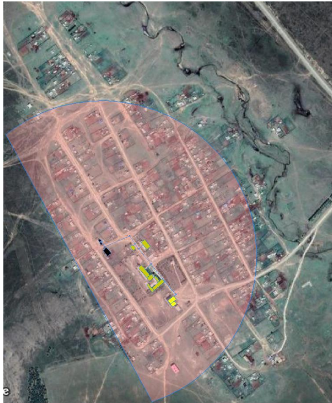
Рисунок 7.15.1. Радиус теплоснабжения котельной Центральная
