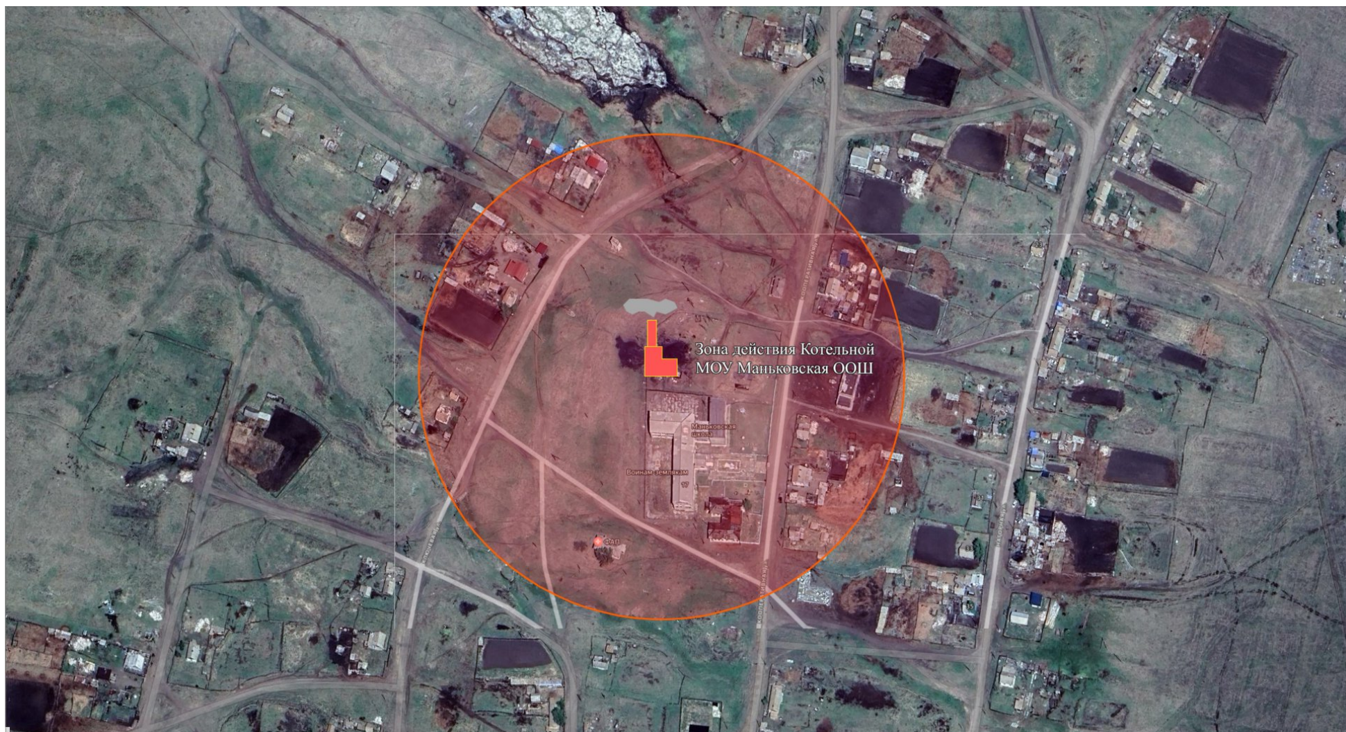
Рисунок 10.5.10 – Зона действия источника тепловой энергии.
