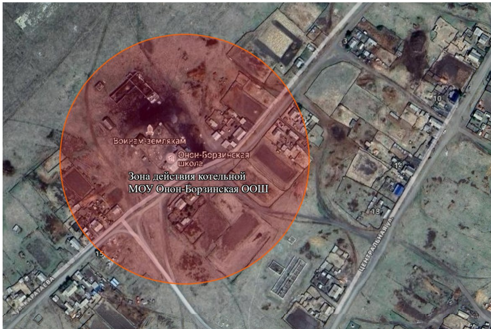
Рисунок 10.5.4 – Зона действия источника тепловой энергии.
