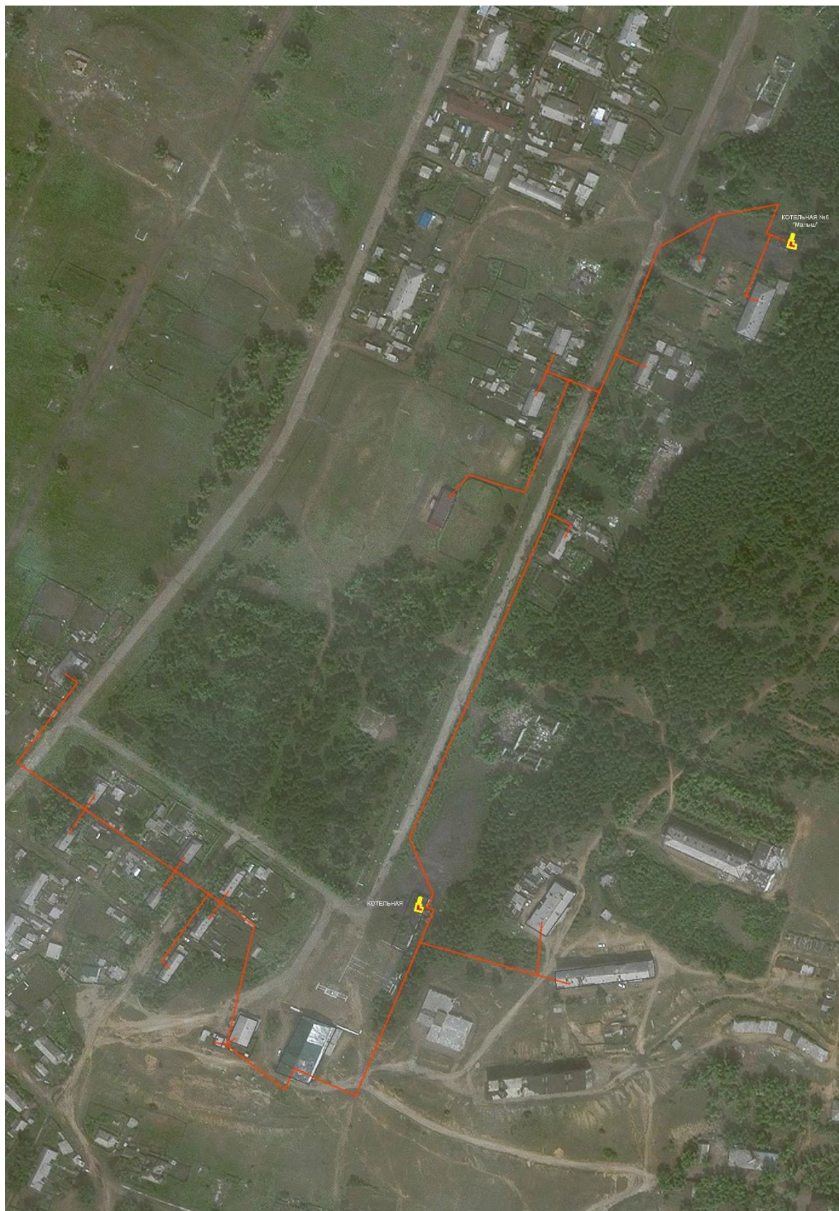
Рисунок 1.3.2.7 - Схема тепловых сетей, п. Букачаха, Котельная №4
