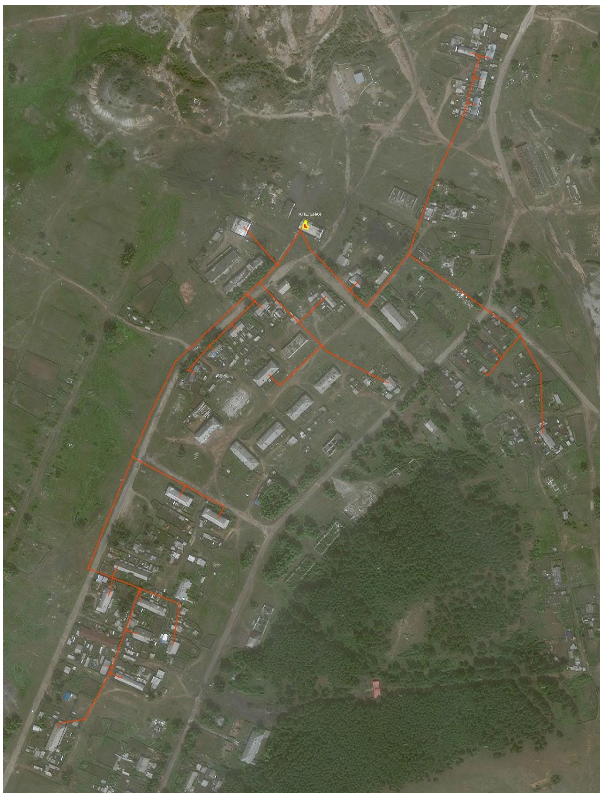
Рисунок 1.3.2.5 - Схема тепловых сетей, п. Букача, Котельная №2
