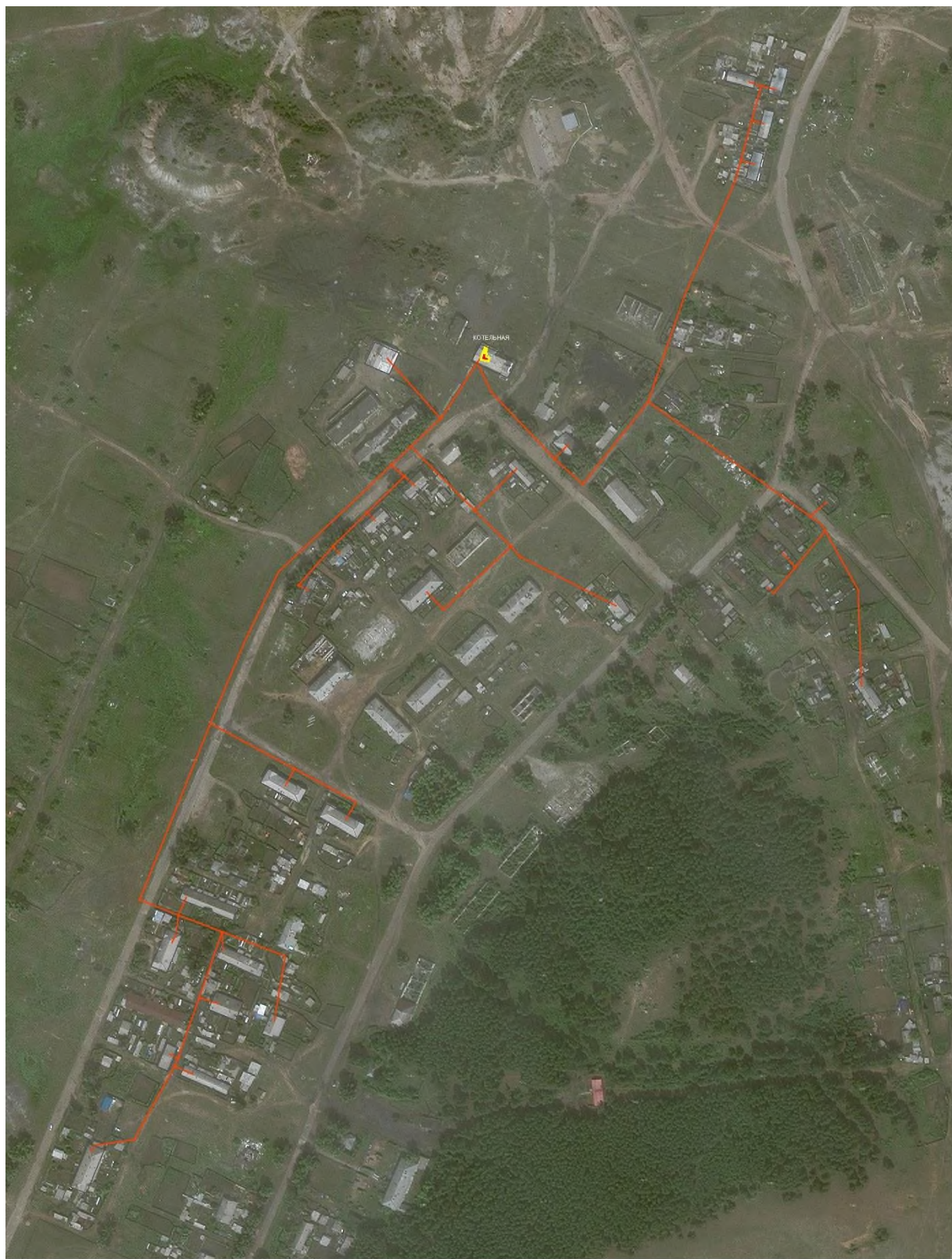
Рисунок 1.12.1.5 - Схема тепловых сетей, п. Букачача, Котельная №2
