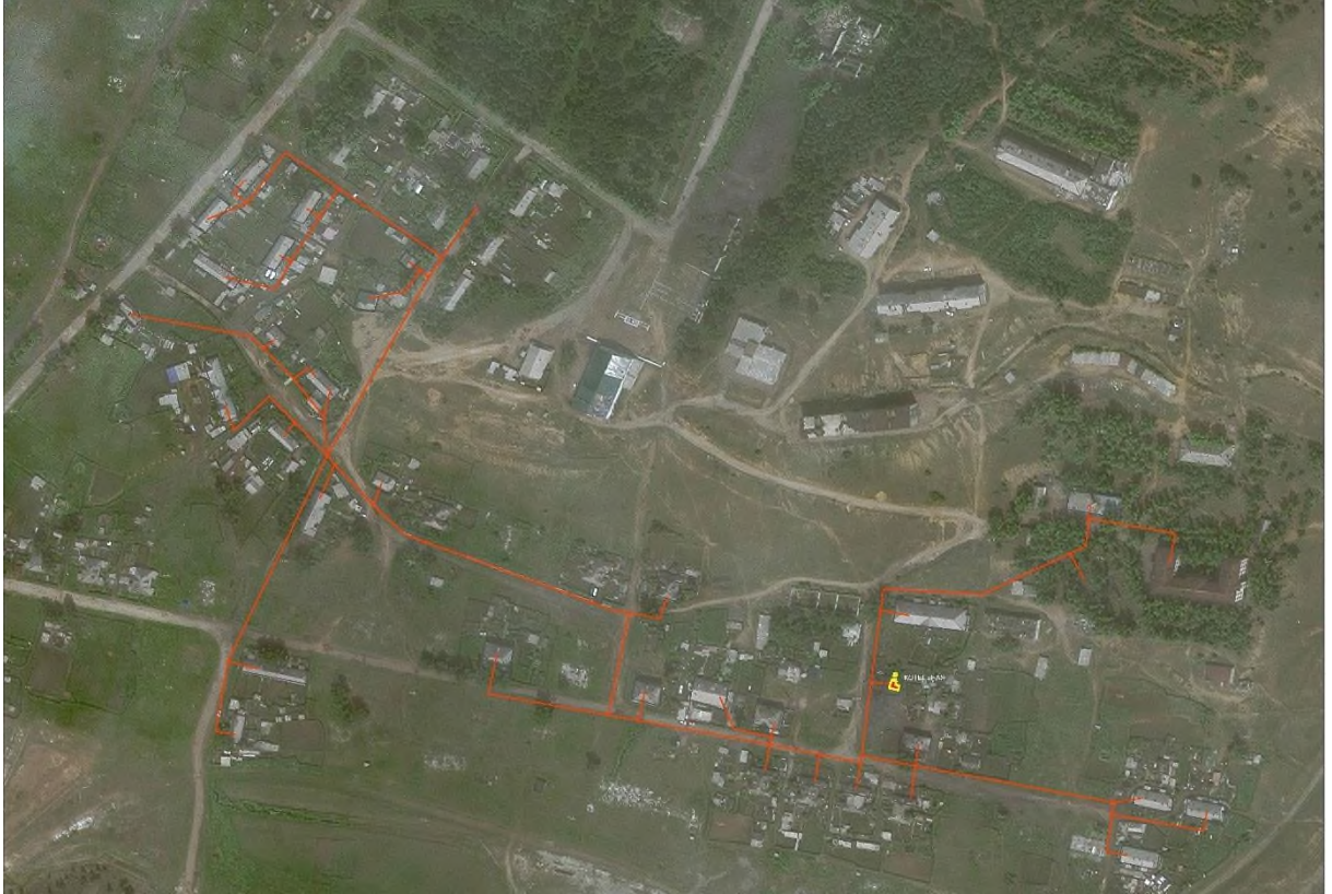
Рисунок 1.12.1.8 - Схема тепловых сетей, п. Букачаха, Котельная №5
