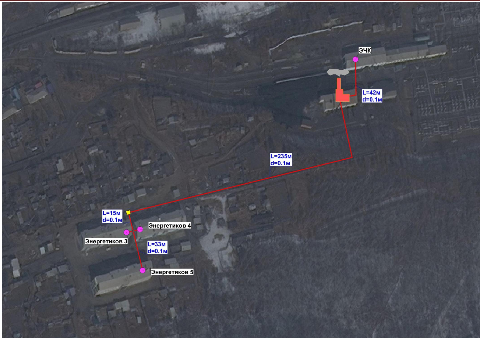
Рис. 2.2 – Схема теплоснабжения городское поселение «Аксеново-Зиловское» от котельной «ДПКС»
