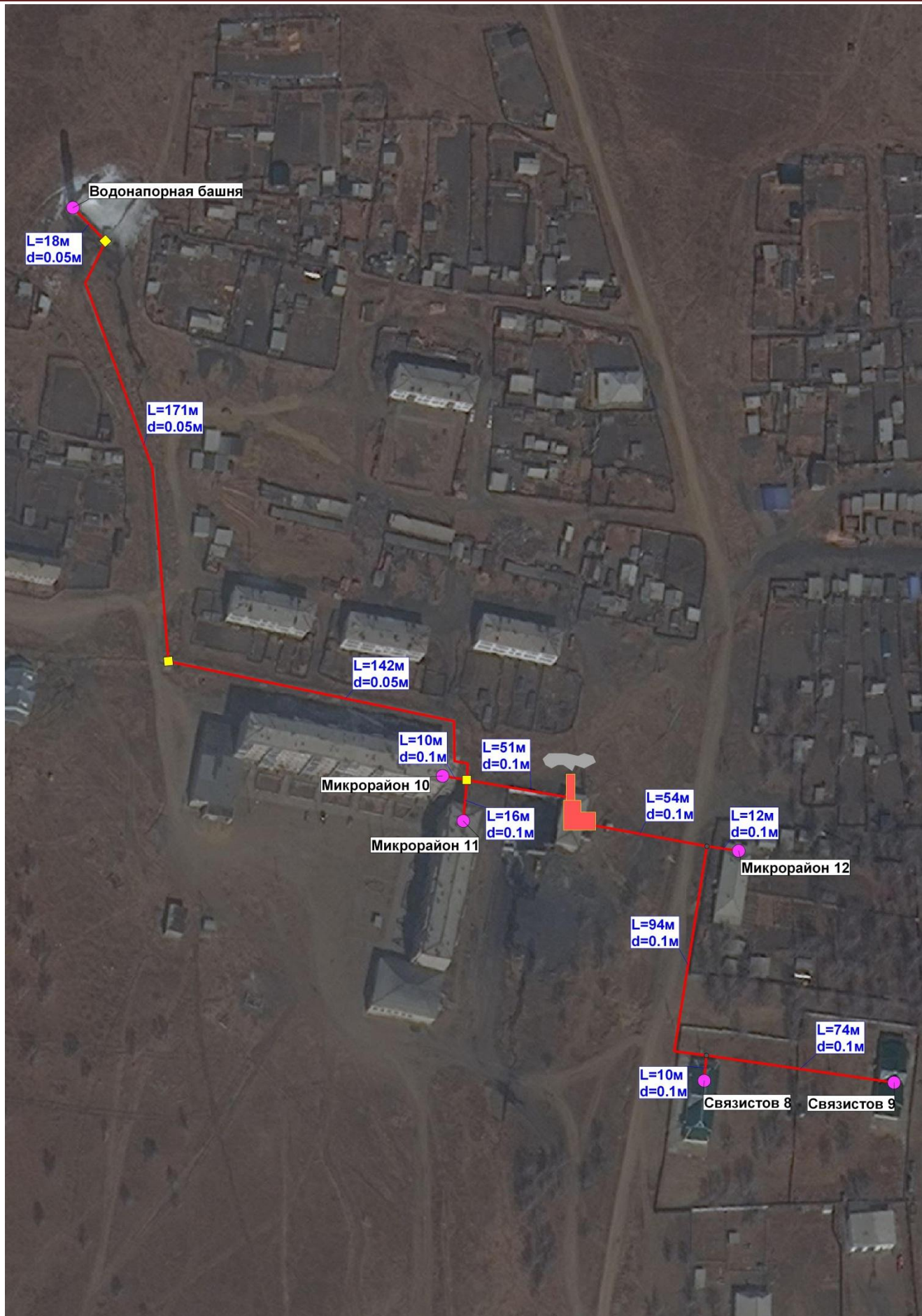
Рис. 2.3 – Схема теплоснабжения городское поселение «Аксеново-Зиловское» от котельной «Березка»
