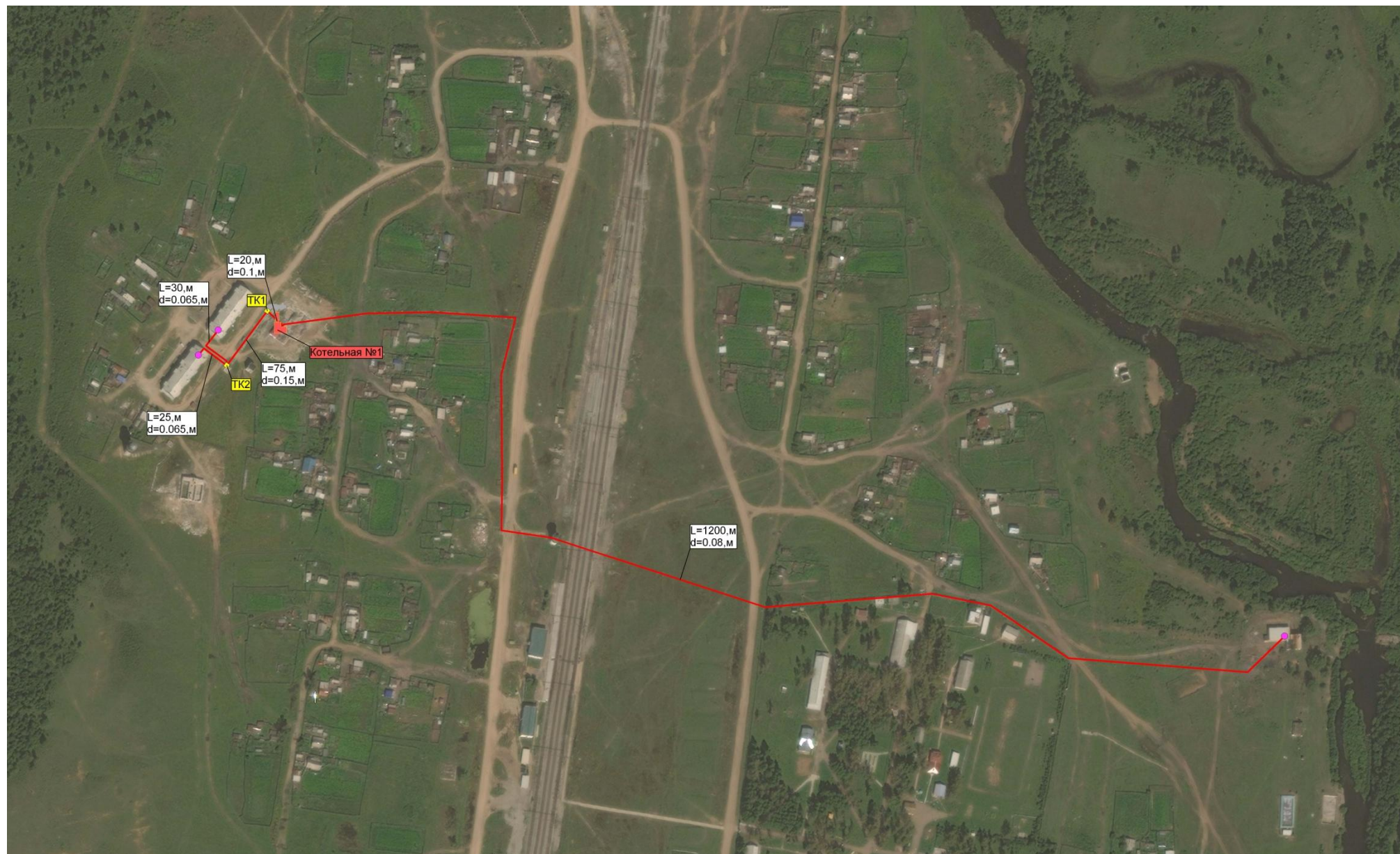
Рис. 2.3 – Схема теплоснабжения муниципального образования сельского поселения "Бушулейское" от котельной №1 на 2013 г.
