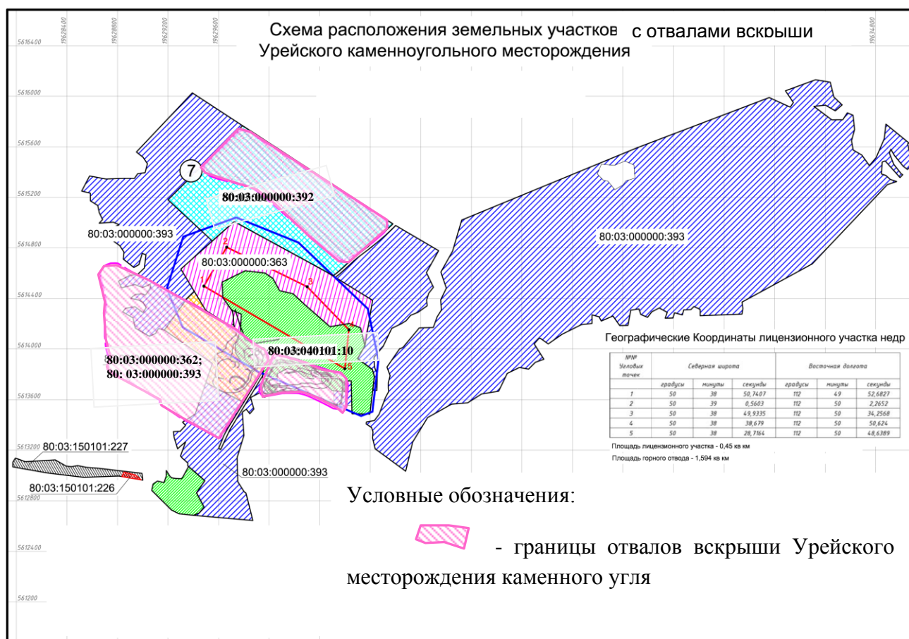
Рисунок 8. Схема расположения отвала вскрыши, относительно других горных объектов и участков Урейского каменноугольного месторождения.
