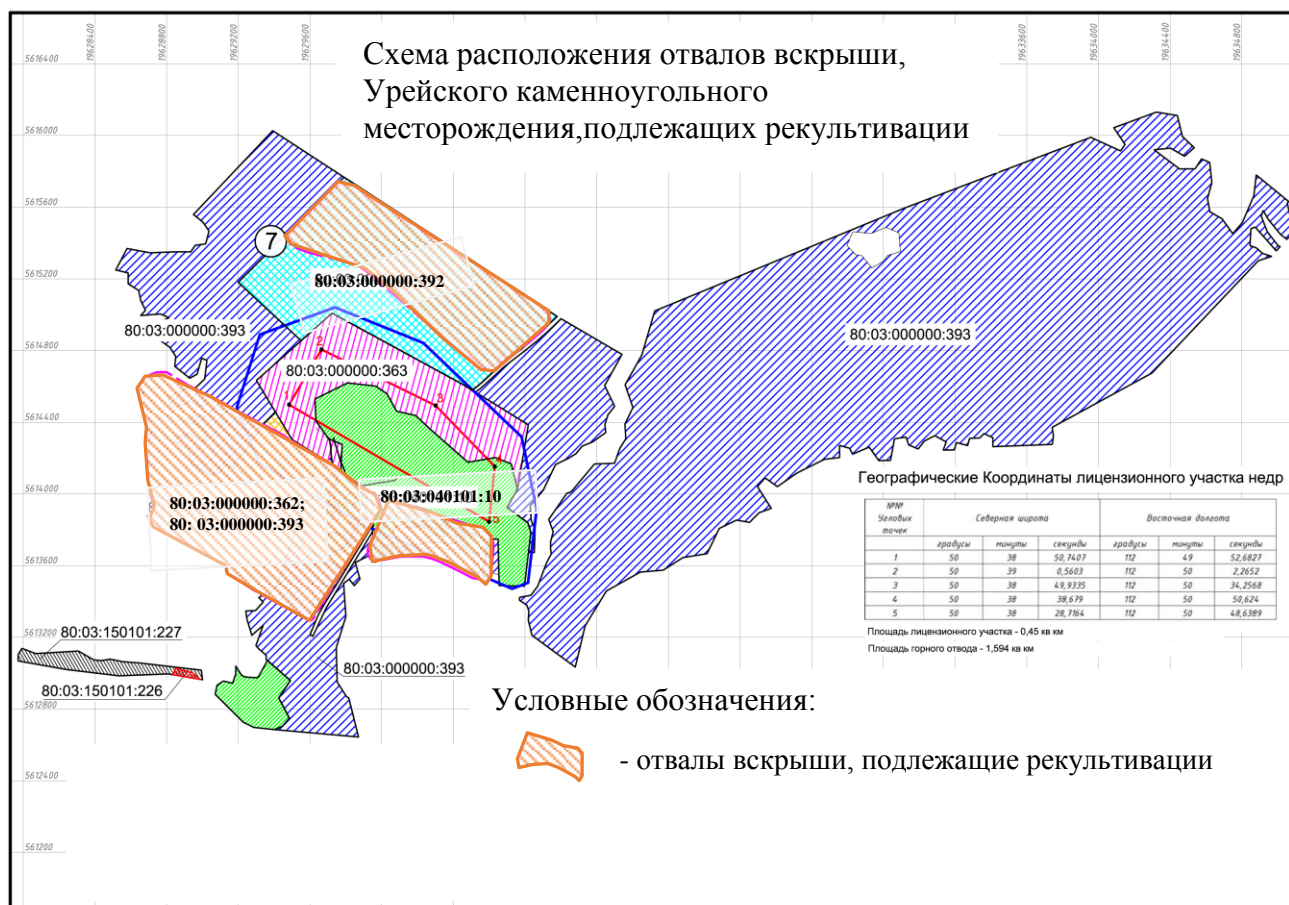
Рисунок 9. Схема месторасположения отвалов вскрыши, подлежащих рекультивации.
