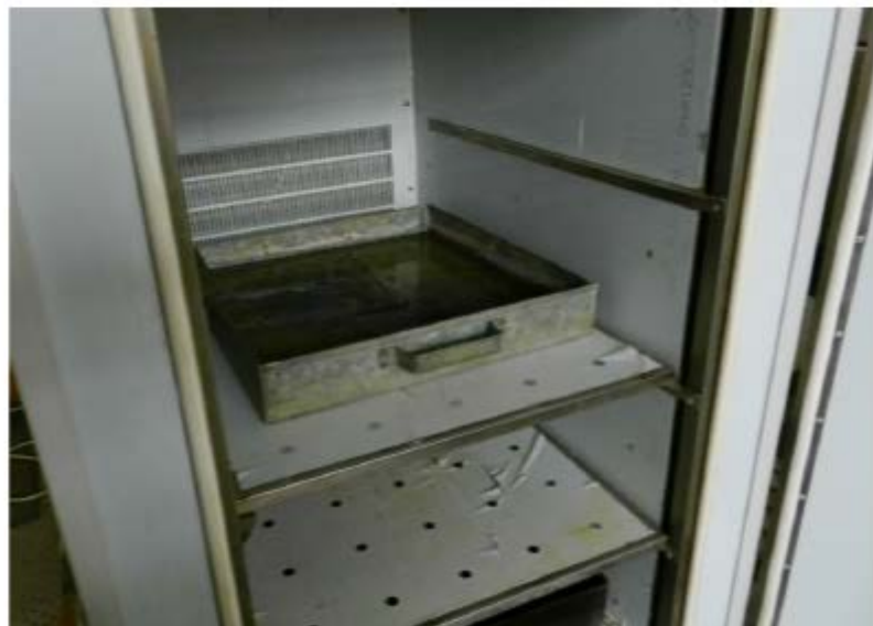
Фото 7 – образцы бентомата в камере тепла и холода
