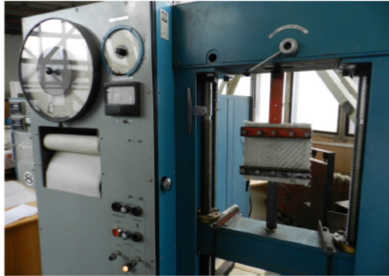
Фото 5 – испытание на разрыв исходного образца бентомата
