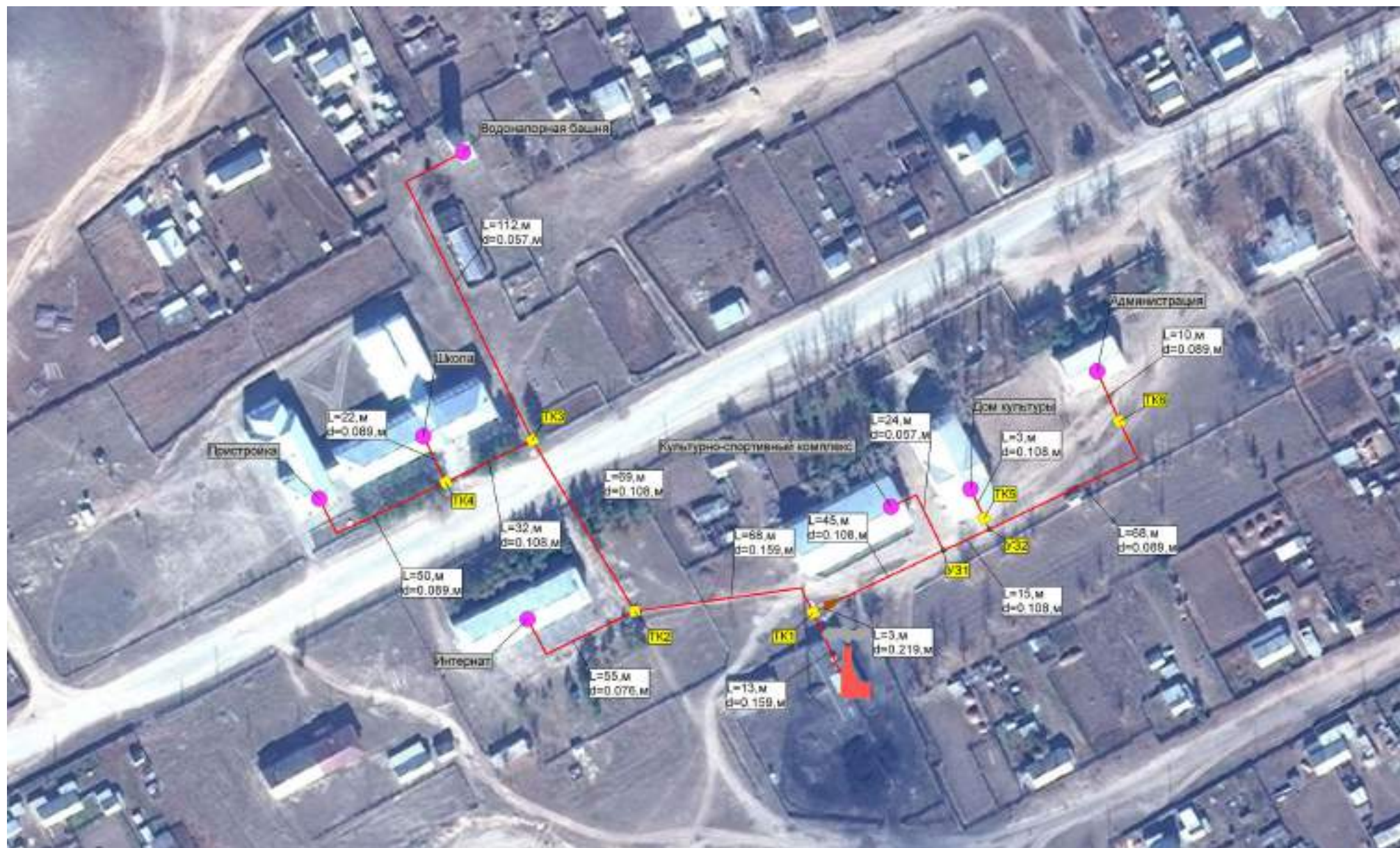
Рис. 2.2 – Схема теплоснабжения муниципального образования сельское поселение "Ага-Хангил" от центральной котельной
