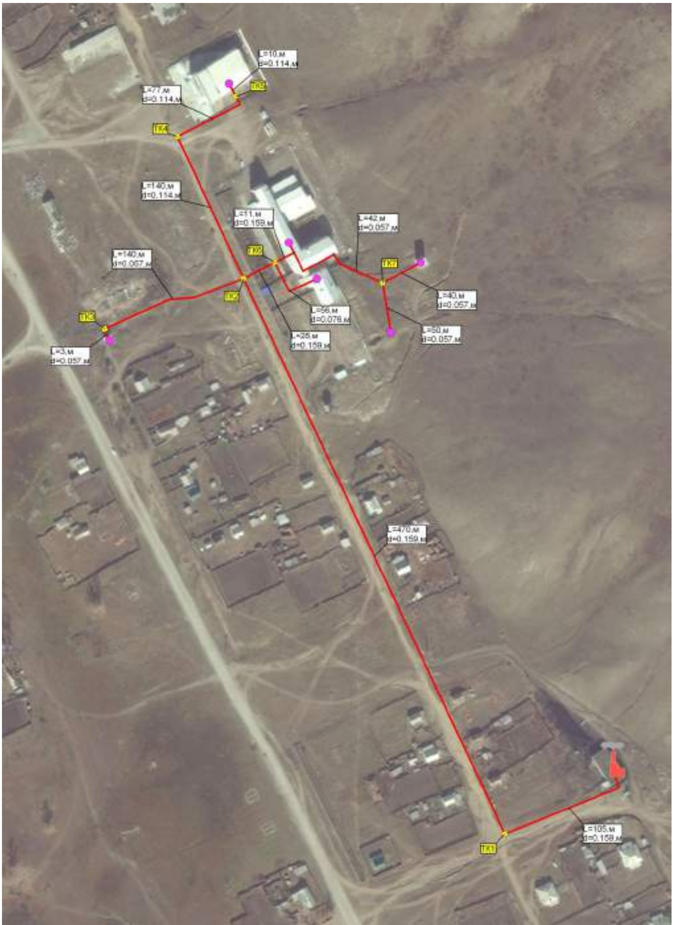
Рис. 2.2 – Схема теплоснабжения муниципального образования сельское поселение «Догой» от центральной котельной
