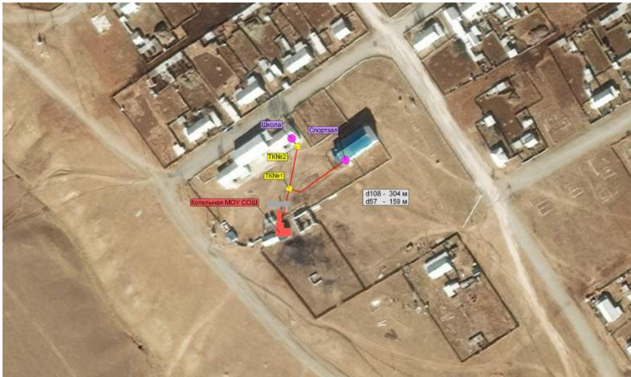
Рис. 2.2 – Схема теплоснабжения муниципального образования сельское поселение «Усть-Нарин» от котельной МОУ СОШ.
