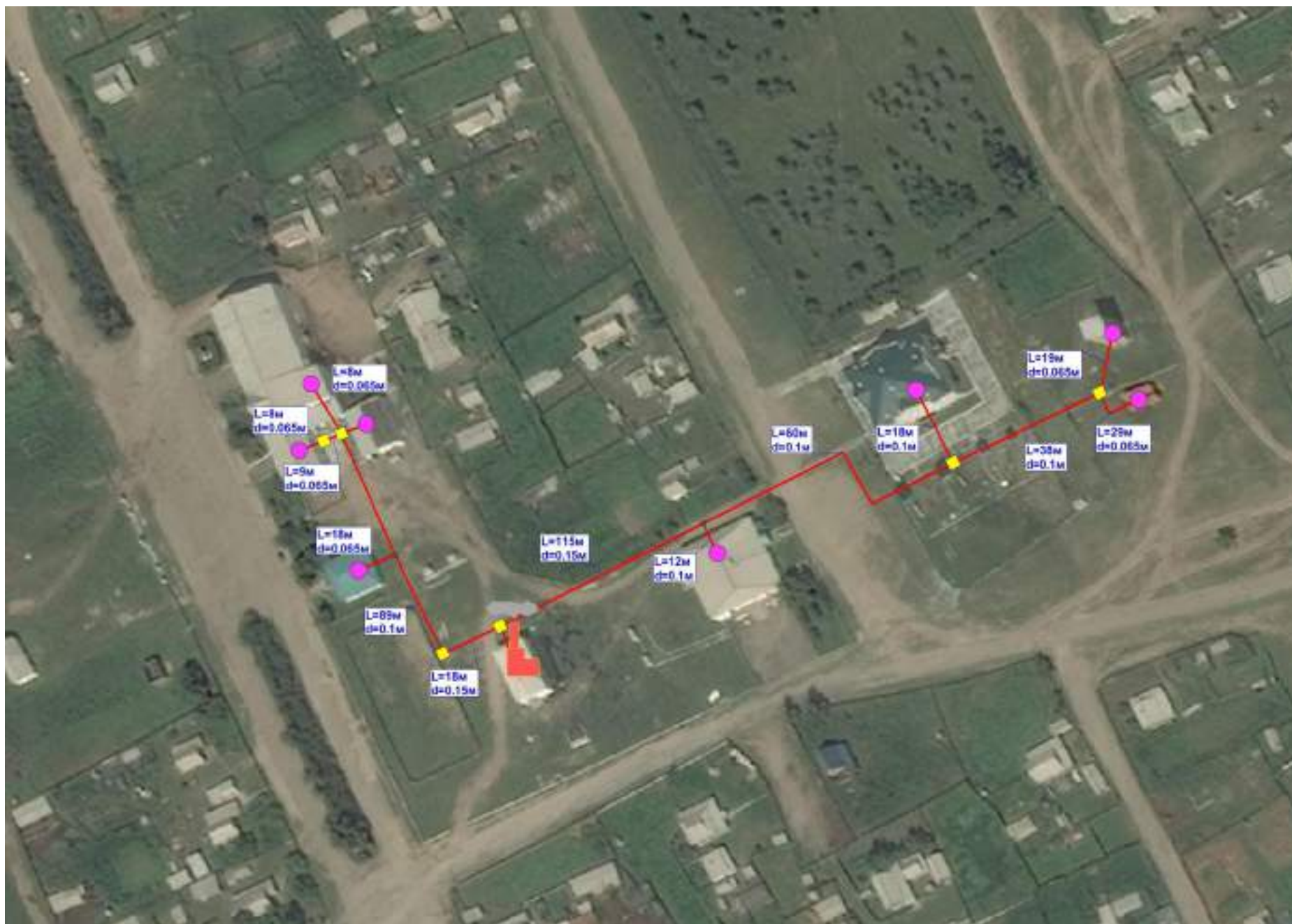
Рис.2.2 – Схема теплоснабжения центральной котельной
