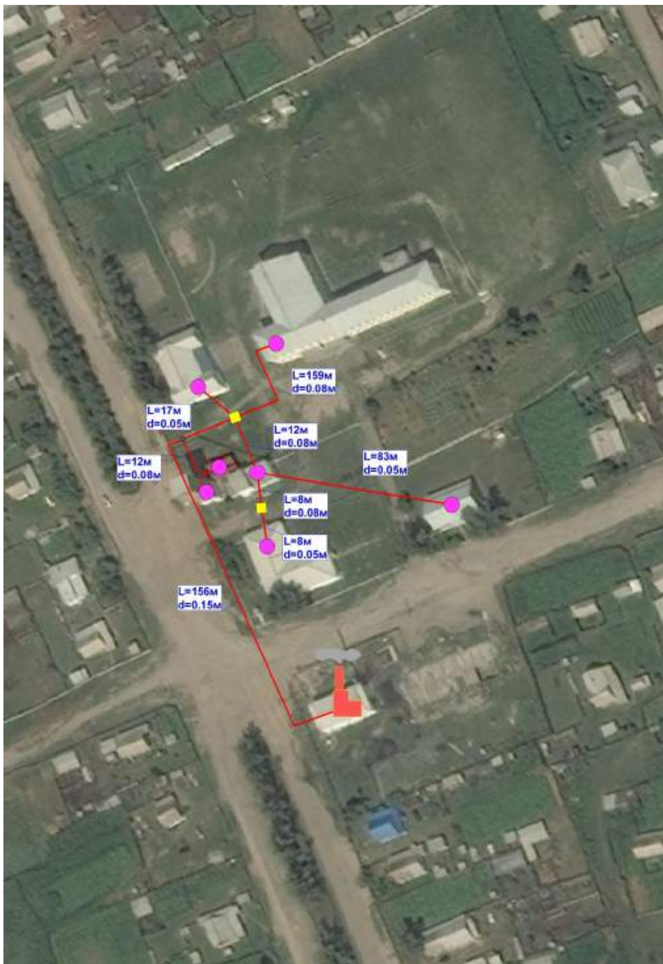
Рис.2.3 – Схема теплоснабжения котельной ЦЧСОШ
