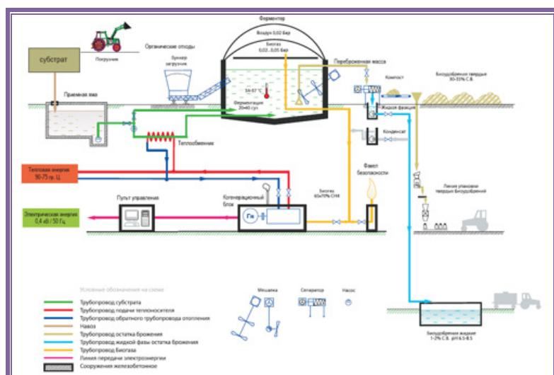
Сырьем для получения биогаза может служить широкий спектр органических отходов – твердые и жидкые отходы агропромышленного комплекса, сточные воды, твердые бытовые отходы, отходы лесопромышленного комплекса. Качество отходов характеризуется влажностью, выходом биогаза на единицу сухого вещества и содержанием метана в биогазе.
