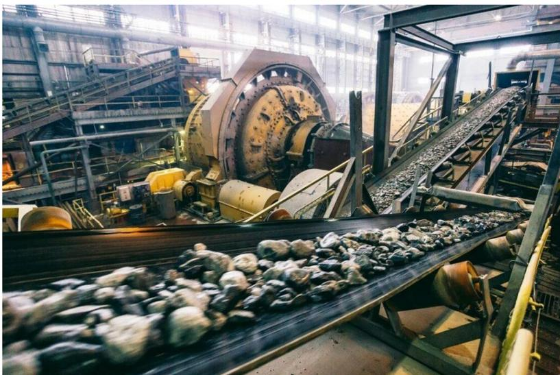
Минтруда России от 18.11.2020 г. № 814н концевой участок ленточного конвейера не оборудован съемными ограждениями, заблокированными с приводом конвейера.
