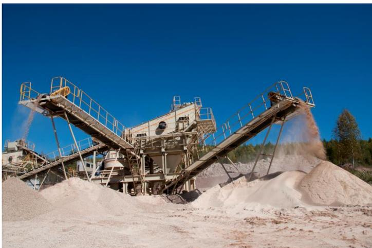
Оборудование использование, которого привело к несчастному случаю: дробильно-сортировочный комплекс Liming, год выпуска 2008, КНР. В составе комплекса входит ленточный конвейер, на котором отсутствует съемное ограждение, сблокированное с пусковым устройством.
