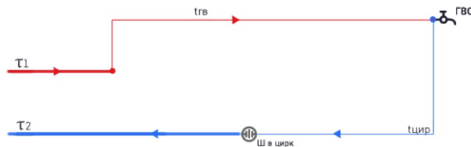
Рисунок 5. Схема присоединения теплопотребляющих установок
