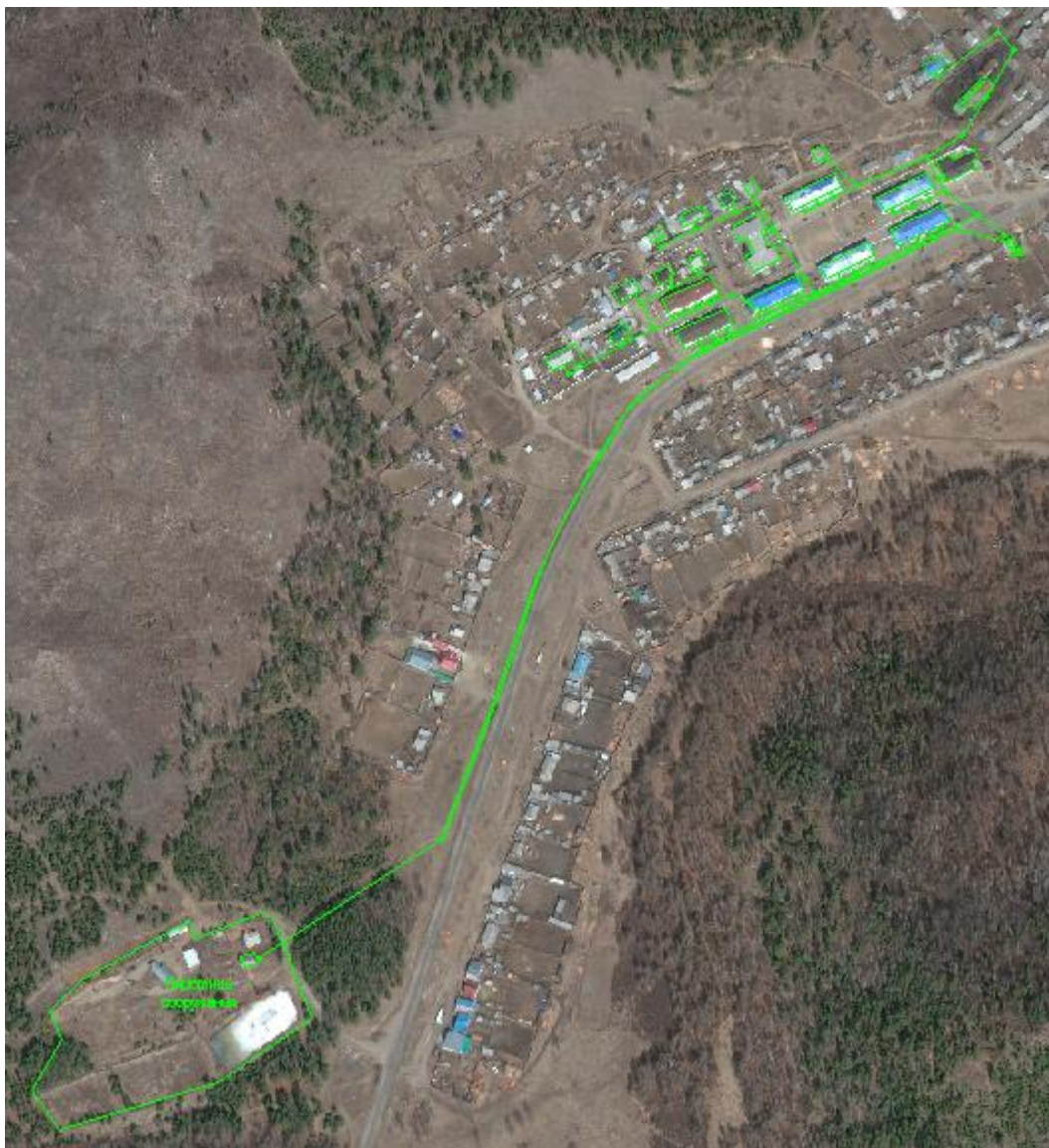
Рисунок 2. Централизованная система водоотведения Балягинского СП
