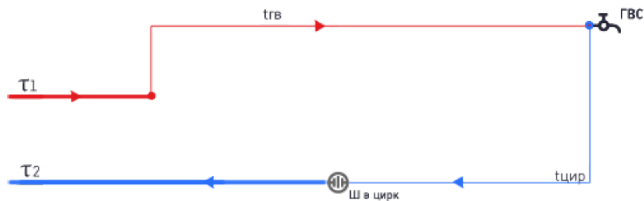
Рисунок 5. Схема присоединения потребителя ГВС
