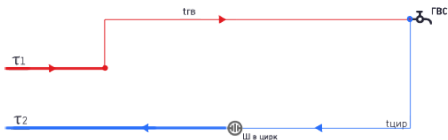
Рисунок 3. Схема присоединения теплопотребляющих установок
