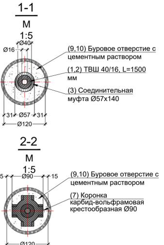
Анкер крепления анкерных оттяжек защитного сетчатого покрытия
