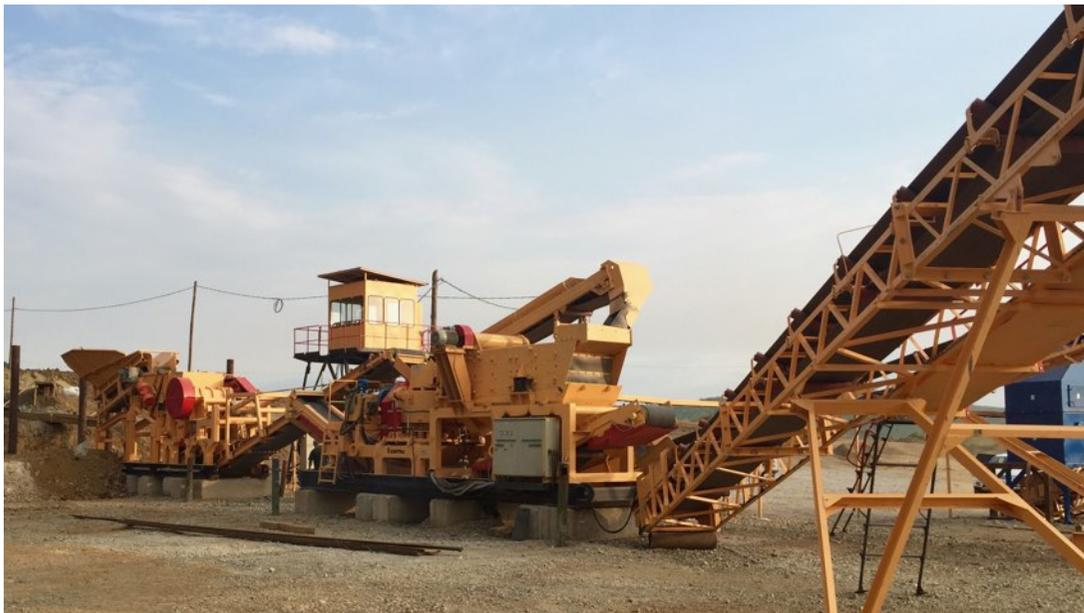
Мобильный комплекс производства железорудного концентрата
